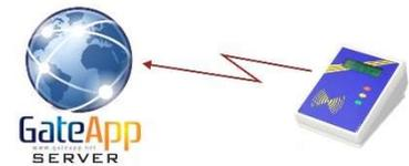
Il Terminale è auto-configurante, alla prima connessione col server GateApp il dispositivo recupererà tutte le configurazioni ed i parametri per il corretto funzionamento.
